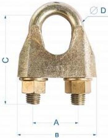
Зажим канатный предназначен для создания соединения веток каната, в том числе при формировании петли. Количество зажимов для надежного соединения определяется путем расчета, но, в любом случае, необходимо использовать не менее трех зажимов. Размер зажимов подбирается исходя из диаметра каната. Зажим канатный соответствующий требованиям DIN1142 производства TOR industries при нормативном использовании обеспечивает надежное и долговечное соединение.
