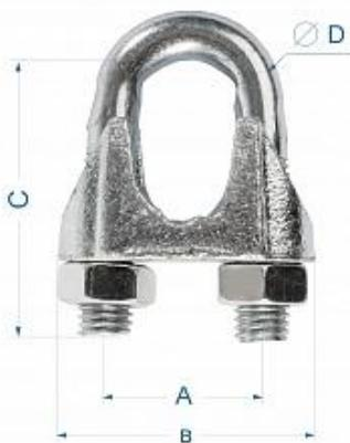
Зажим канатный предназначен для создания соединения веток каната, в том числе при формировании петли. Количество зажимов для надежного соединения определяется путем расчета, но, в любом случае, необходимо использовать не менее трех зажимов. Размер зажимов подбирается исходя из диаметра каната. Зажим канатный соответствующий требованиям DIN741 относится к облегченному классу и рекомендуется для использования при проведении работ, не предполагающих значительные усилия к соединению.
