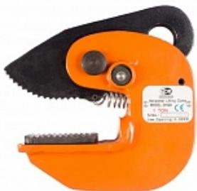
Захваты механические типа DHQA применяются для подъема и перемещения листового металла в горизонтальном положении. Используются попарно. Предназначены для работы в режиме 1М, класс нагружения В1 по ГОСТ 25835, климатическое исполнение У1 по ГОСТ 15150. Захваты механические типа DHQA соответствуют требованиям Технического регламента Таможенного союза - ТР ТС 010/2011 "О безопасности машин и оборудования".
