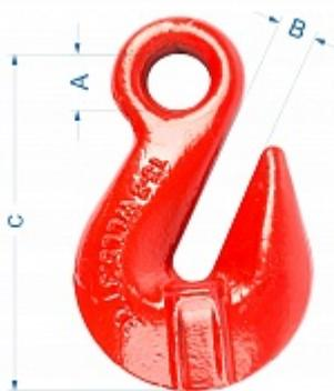
Крюк стальной укорачивающий не является концевым элементом. Применяется для регулировки длины ветви цепного стропа. Подбирается в соответствии с размером цепи и грузоподъемностью ветви стропа. Характеристики: 4-х кратный запас прочности на разрыв (8 класс прочности), имеет статичную проушину. Использование комплектующих 8-го класса прочности производства TOR industries позволяет снизить вес стропа при сохранении нормативных параметров надежности.
