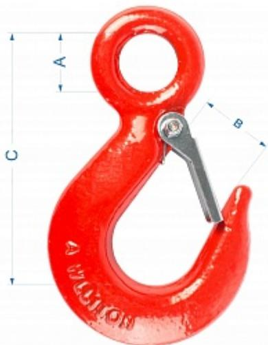
Крюк стальной тип 320А применяется при изготовлении цепных, канатных и текстильных стропов (чалок), а также при проведении буксирных и такелажных работ в качестве концевого элемента. Характеристики: 4-х кратный запас прочности на разрыв (8 класс прочности), имеет статичную проушину, оснащен пластинчатым замком. Использование комплектующих 8-го класса прочности производства TOR industries позволяет снизить вес стропа при сохранении нормативных параметров надежности.
